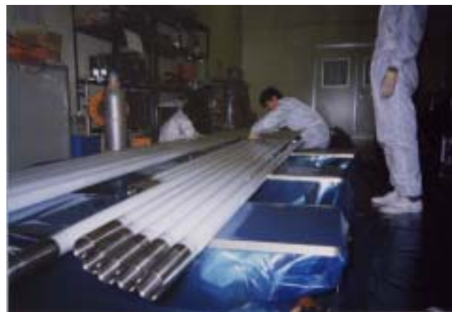
図 6. 純化装置でのラドンしみ出し防止策
