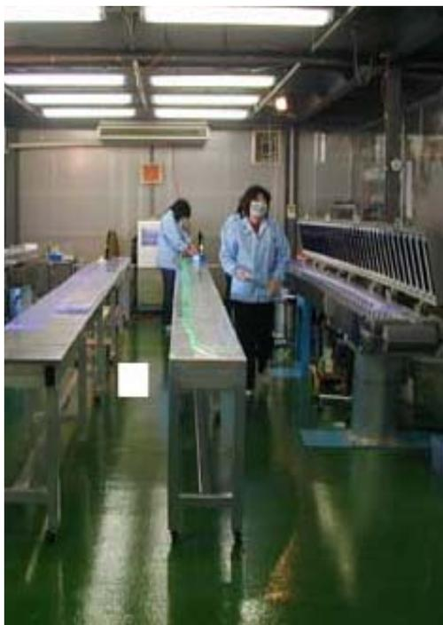
図7：ファイバーの接着作業風景
