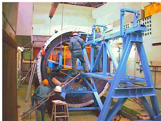
図 13：中央部にメイン・バレルを組み込む風景
