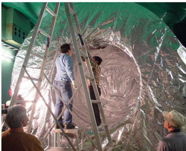
図 15：真空分離膜の設置
