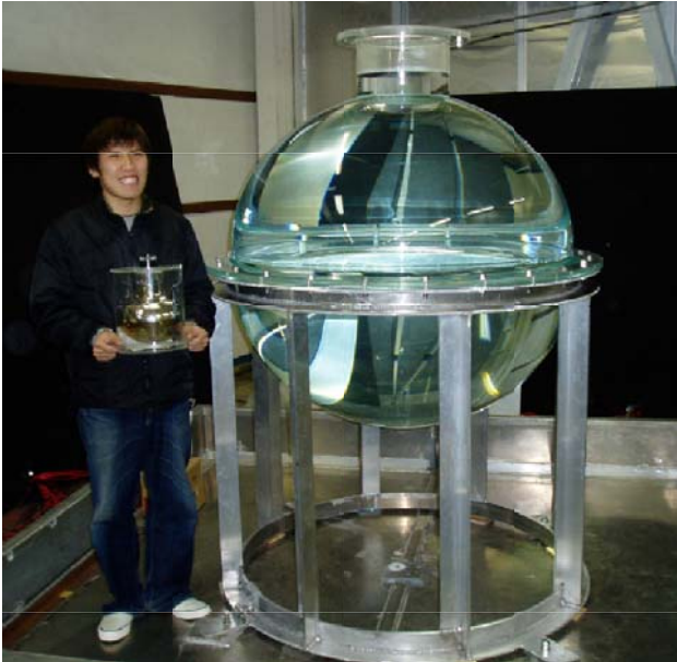
図 22 プロトタイプ検出器用アクリル容器と PMT 容器
