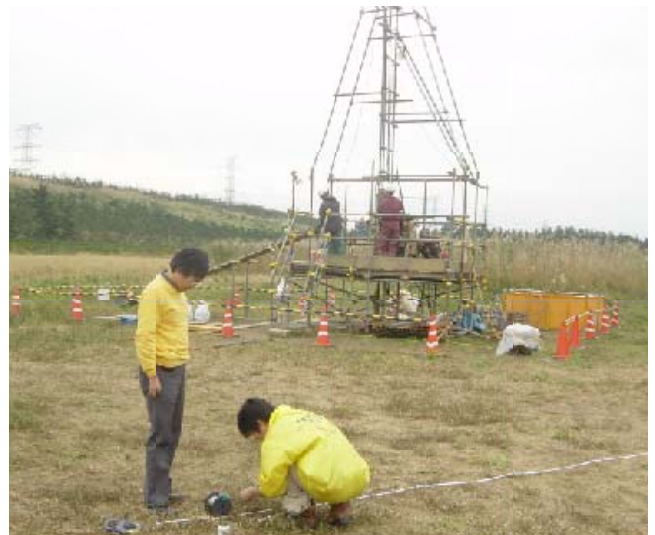
図 18 柏崎刈羽原子力発電所敷地内でのボーリング/ 地中バックグラウンド測定。
