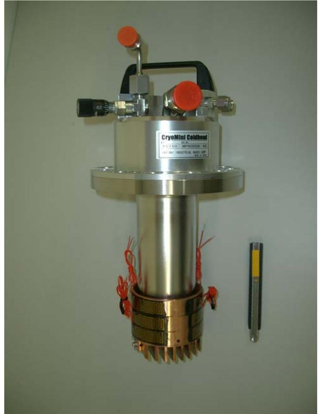
図5. MEG実験実機用200W@165Kパルス管冷凍機 岩谷瓦斯（株）の協力により作製した。右下は寸法比較のためのカッターナイフである。
