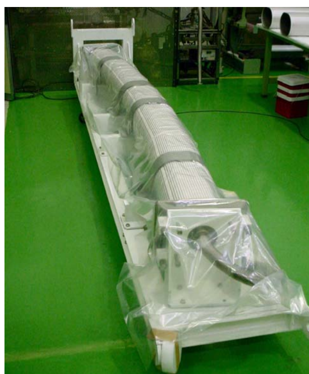
図 11 BM 用セラミックス真空ダクト
