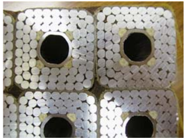
図 14 ポリイミド樹脂を含浸してコイルに成形されたストランド線の断面図
