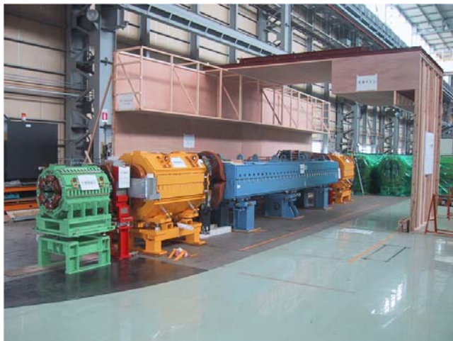
図 18 アーク部のモックアップ —セルのすべての電磁石が並んでいる。
