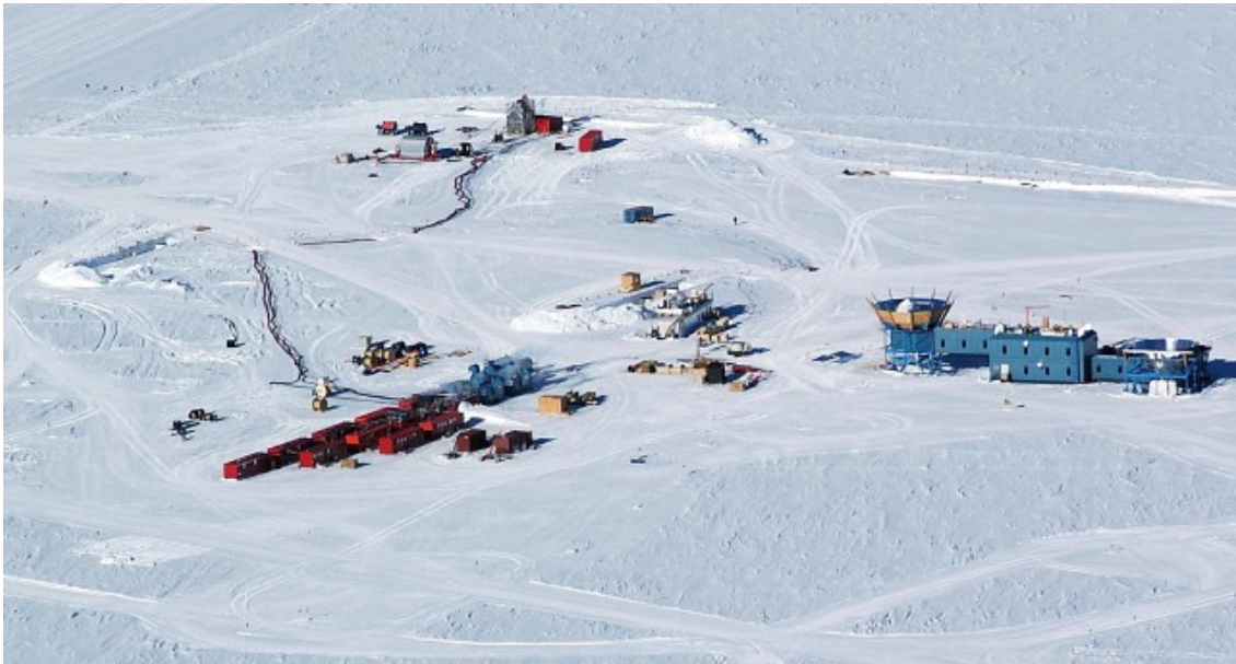
図1 上空から見た IceCube 建設現場 (写真は全米科学財団の支援によりウイスクンシン大学提供) 中央上にドリルハウスおよび検出器埋設用ハットが見える。
