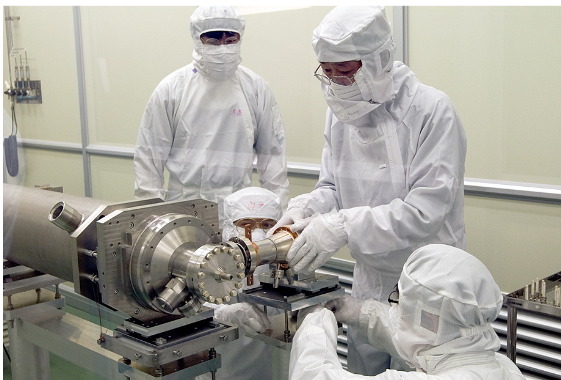
図 8-1 STF クリーンルームにおいて組み立て中の超伝導加速空洞 (TESLA 型空洞の組み立て)
