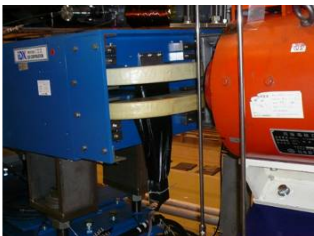
写真5 上：ストリップシンチレータを用いた電子モニター 下：上の電子モニターをベンディングマグネットの正面に取り付けたところ
