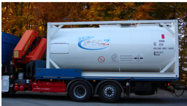
図 16 \gamma -catcher 運搬用液シン用タンク Photo courtesy by Max-Planck-Institute for Kernphysik.
