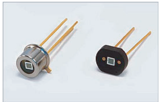
図 1: 浜松ホトニクスより発売された MPPC の外観 [1] (左:CAN パッケージ, 右:セラミックパッケージ)。センサー受光部面積は共に 1 \times 1 \text{ mm}^2 。
