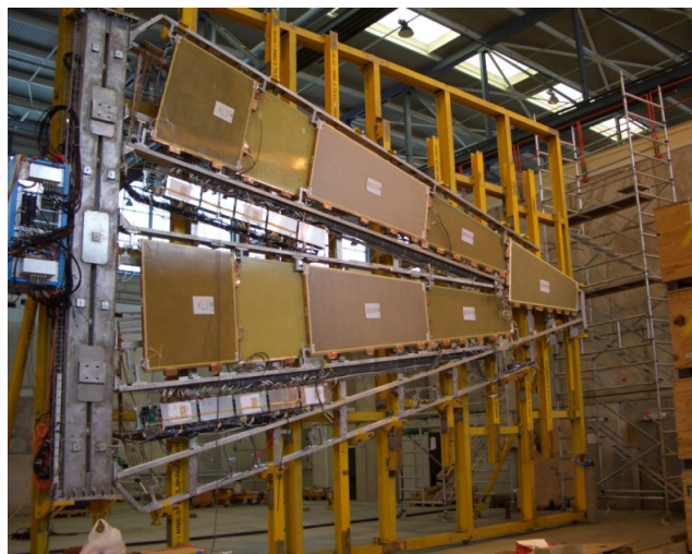
図6 サービスインストールが済んだセクターを黄色いテーブルごと 90 度回転させ、表面にチェンバーをインストールしたところ
