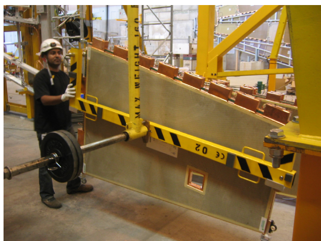
図7 チェンバーインストールのための吊り具
