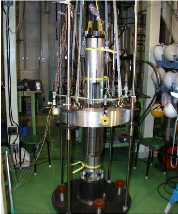
図5 1mモデル磁石開発の様子：カラーリング
