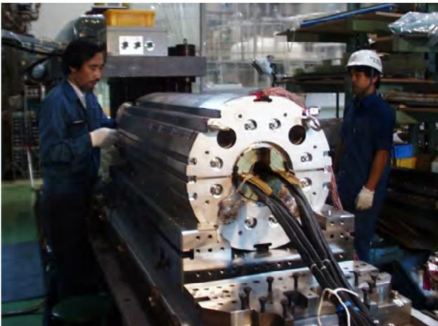
図6 1mモデル磁石開発の様子：ヨーキング
