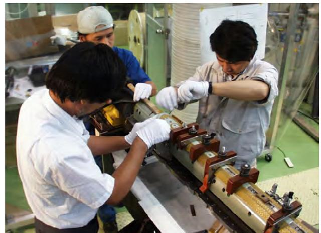
図4 1mモデル磁石開発の様子：コイル巻き線
