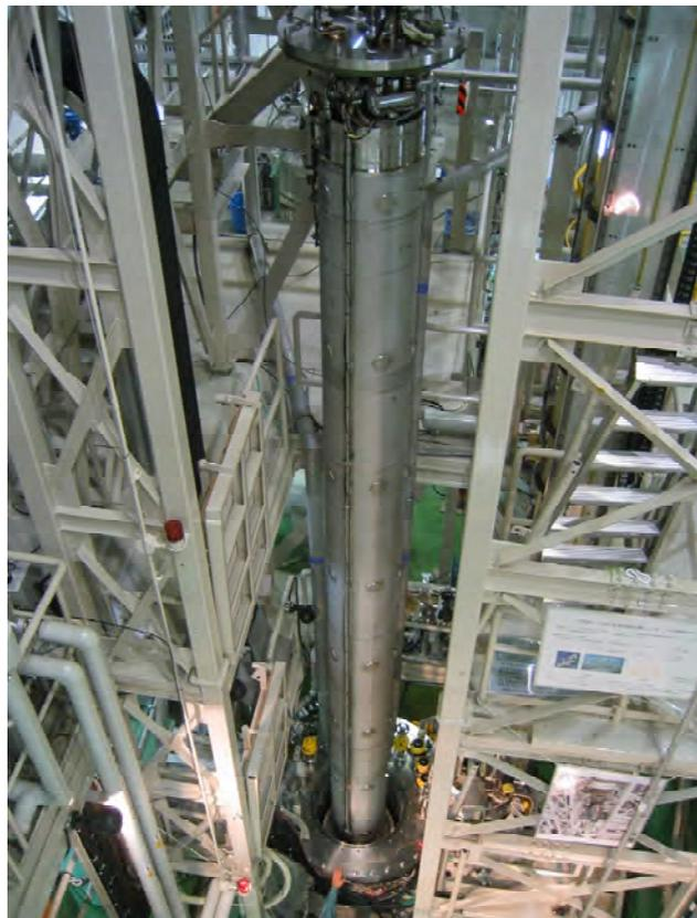
図7 MQXA 実機磁石の励磁試験準備
