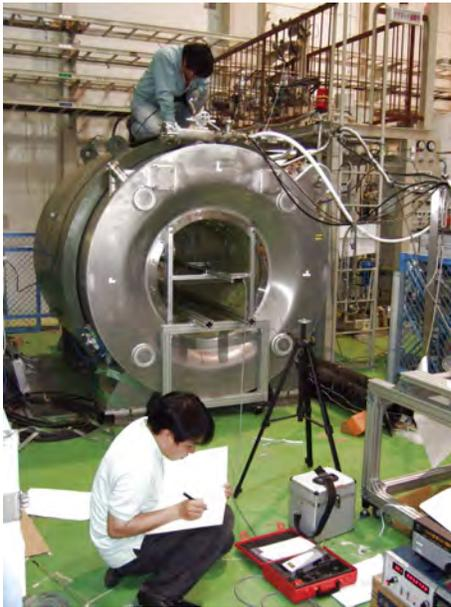
図 6: 使用する超伝導磁石。直径 80 cm, 長さ 2 m の大きな空間に均一な磁場を印加できる。
