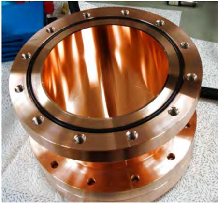
図 8: TM110, 2.856 GHz 共鳴空洞 (内径 128 mm, 深さ 100 mm)。測定により,  $Q \approx 14000$  が得られた。
