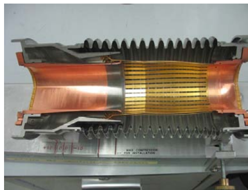
図 4 ビームスクリーンを低い電気抵抗でつなぐための plug-in module。写真はビームスクリーンが冷やされた時の相対位置状態を示している。
