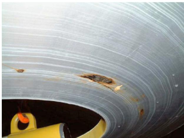
図10 コアの放電による損傷
