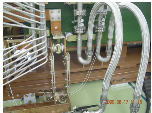
図5 電力接続のナイフスイッチと冷却水のクイックコネクタ
