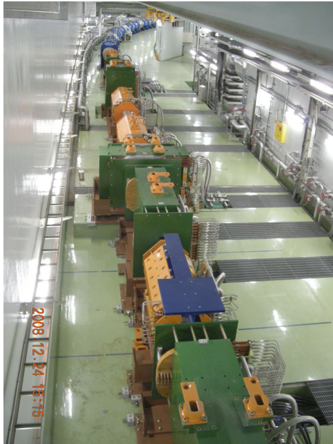
図2 最終収束部の常伝導電磁石概観
