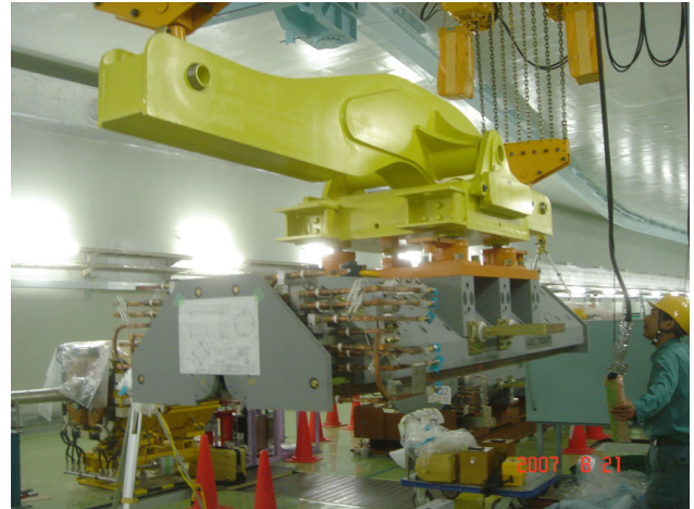
図4 ツイストロックでの吊り上げ
