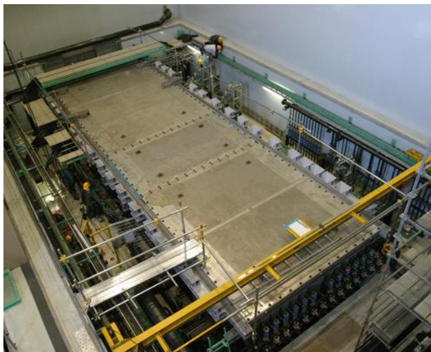
図 21 真空試験中のヘリウム容器
