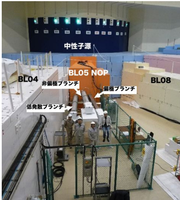
図2 J-PARC 物質生命研究施設中性子ビームラインBL05: 中性子光学基礎物理測定装置(NOP: Neutron Optics and Physics)
