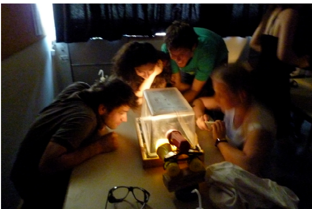
図 8 Cloud chamber で宇宙線を観測 無事宇宙線を観測することができた。
