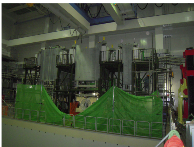
図11 調整架台に設置された電磁ホーンと支持モジュール
