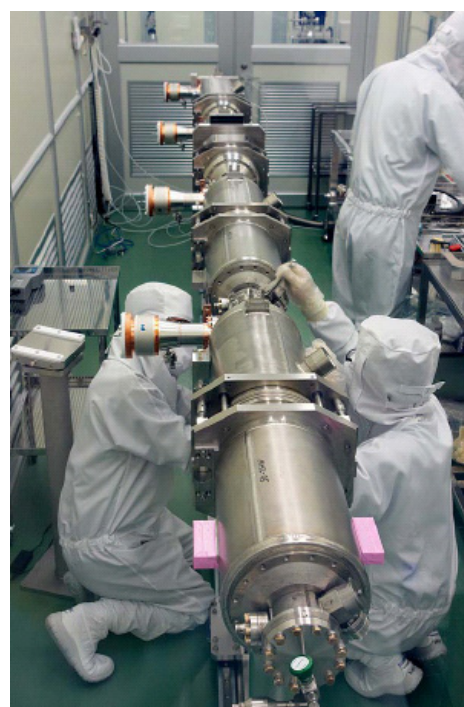
図10 KEK 空洞の4連化組立て作業
