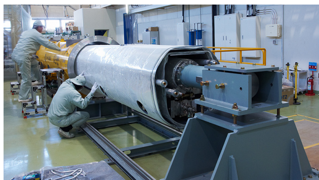
図 18 真空容器への Module-C コールドマスの挿入
