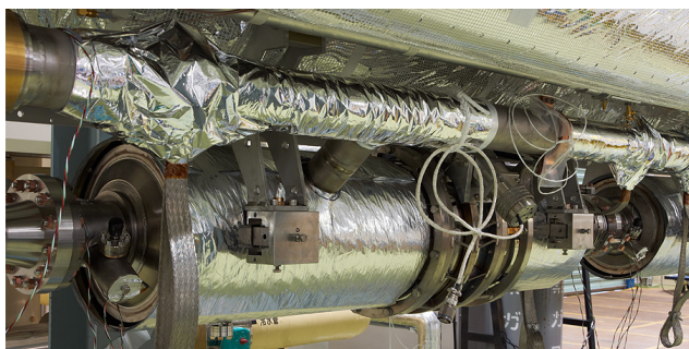
図 17 ガス回収配管への FNAL 空洞の取付け
