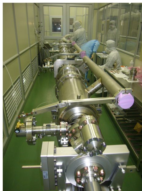
図9 FNAL/DESY 空洞の4連化組立て作業
