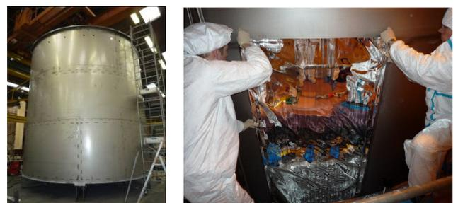
図 5 バッファータンク(左)と、バッファータンク外壁面に反射材を貼るドイツグループのメンバー(右)
