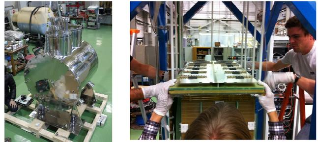
図 18 テスト中の新容器 (左) および 2 次元読み出しアノード (右) の写真。
