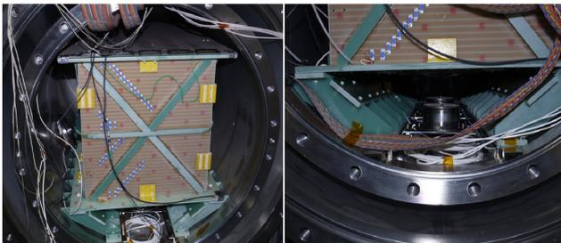
図4 容器内に設置されたTPC検出器(左)、および容器下部に設置した2本の光電子増倍管(右)。
