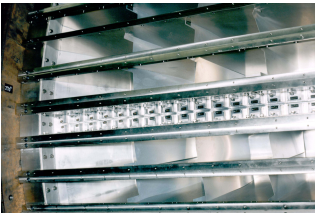
図7 アルミ薄板で作られたECLコンパートメント。中央の列に結晶モジュールがインストールされているのが見える。
