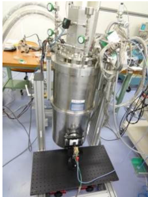
図 1: KEK の 0.3K 無冷媒冷凍機の外観。
