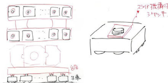
図5: 回転法の模式図。左上) Belle を上から見た図。左下) Belle をビーム軸から見た図。右) 台車の改造のアイデア図。
