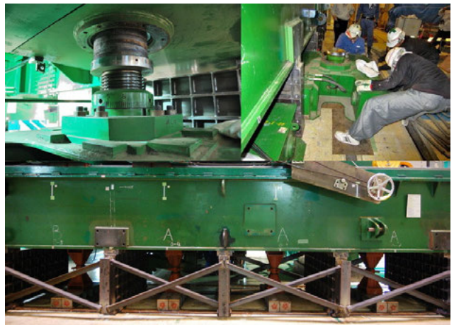
図 6: 台車取り外しの様子
