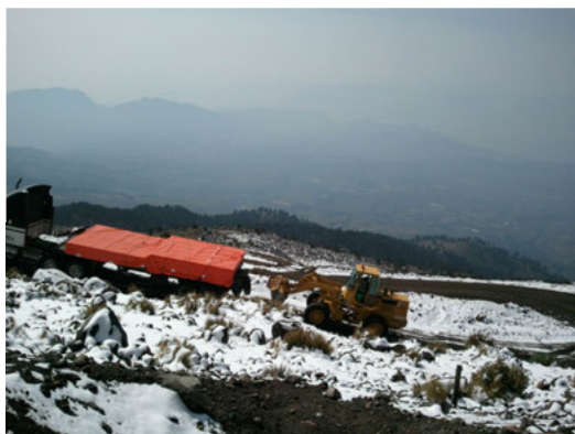
図 17: 山頂へ輸送される SciCRT 検出器 (オレンジのシートの中)。装置が重いため、ぬかるんでトラックが自力では進めず、ショベルカーで押しながら山を登っている。
