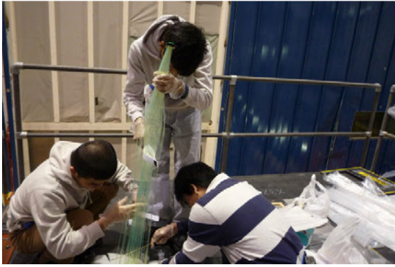
図 5: FNAL でのファイバ抜き取り作業の様子。ファイバは INAOE で再び挿入するので、その時作業がしやすいようしおりをはさんでいる。
