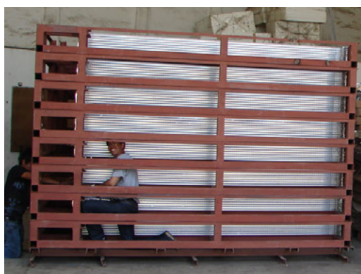
図 10: 完成した架台と鉛直に向き直った検出器。シンチレータバーと架台の間の人が入っている隙間は MAPMT を収めるスペースである。
