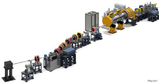
図 7 量子ビーム加速器の概念図。フォトカソード RF 電子銃と捕獲クライオモジュール(右上)により得られる 50MeV の電子ビームとレーザー光蓄積装置(左下)内のレーザーとの衝突により大強度高品質 X 線を発生させる。
