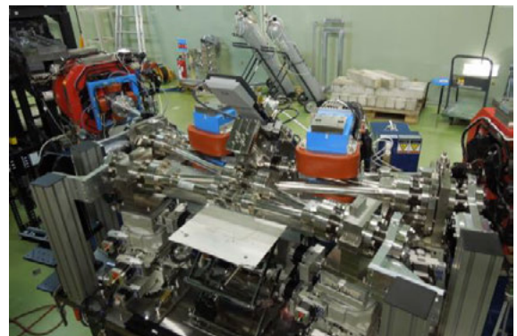
図 8 大強度高品質 X 線を発生させるための 4 ミラー・レーザー蓄積装置。
