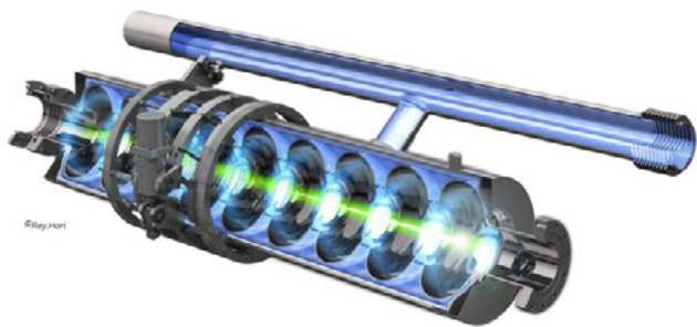
図 3 超伝導加速空洞パッケージの概念図。青(周辺部)：液体ヘリウム、緑(中心部)：加速電場の集中する部分を表す。
