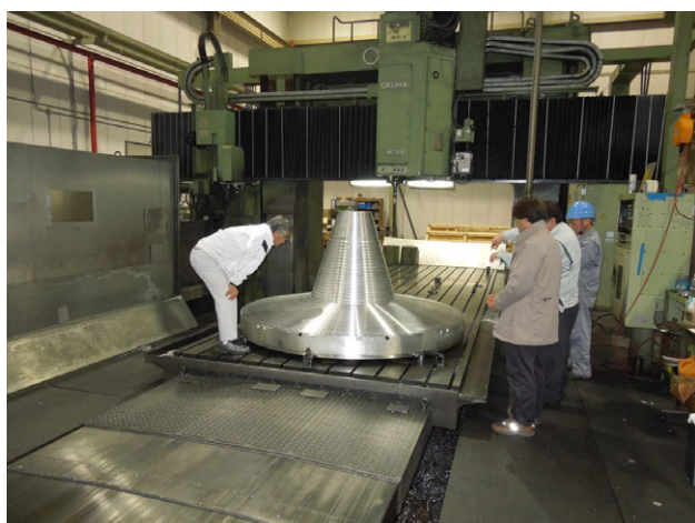
図5: 前方のエンドプレート。スモール、コンカル、メインの3つの部分が組み上げられている。
