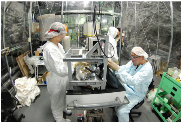
図 4: クリーンルーム内での PMT フレーム装着作業
