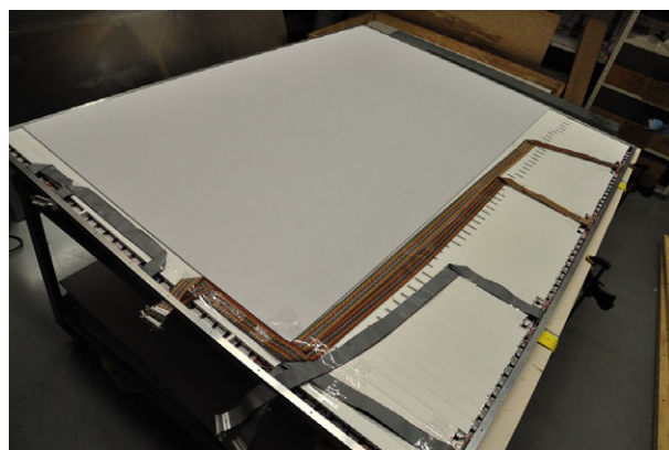
図 4: バレル KLM モジュールの写真。これは第 2 層用である。
