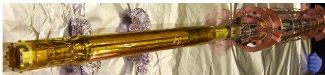
図 18 ALPHA-2 Atom Trap 写真。左が反陽子ビーム側，右が陽電子線源側である。
