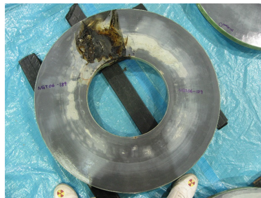
図7 座屈，損傷した高周波加速空洞コア。
