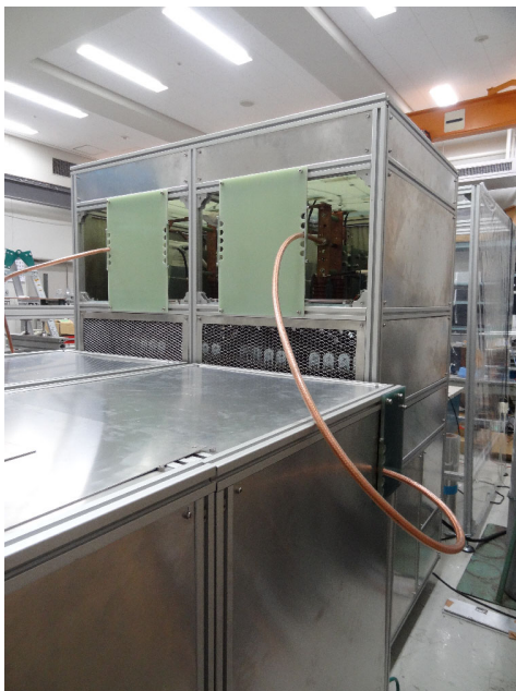
図 13: われわれが新たに制作したコンデンサバンク
