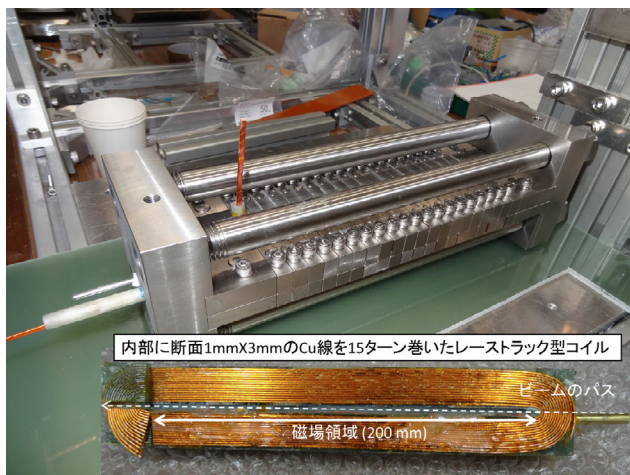
図 10: パルス磁石の写真。X 線はレーストラックコイルの内側の空間を紙面右手奥から左手前に斜めに通過する。
