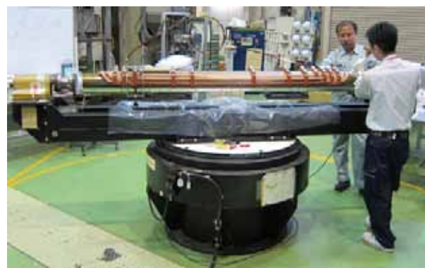
図 15 2m モデル磁石用超伝導コイルの巻き線の様子。
