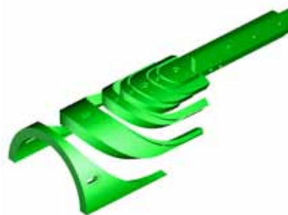
図 14 ROXIE 3Dモデルを元に作成したエンドスペーサーとランプボックスの 3D CAD モデル。
