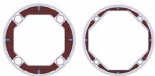
図 6 HL-LHC におけるビームパイプとシールド断面図。左は Q1, 右は Q2-D1 に挿入される。外側が SUS316LN 製ビームパイプで、外周面が超伝導コイル内周面と接することになる。ビームパイプとビームスクリーン(正八角形)の間にあり、メディアンプレーンをカバーしているのがタングステン製シールド。スクリーンとシールドへの入熱は、4本の銅管を通るヘリウムガス(40-60 K)で冷却される。
