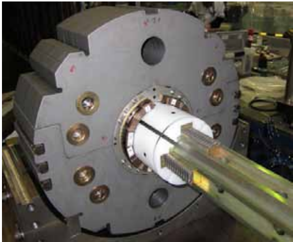
図 16 機械構造検証用断面モデル。コイル変形を抑えるため口径内部にカラーリングマンドレルが挿入された状態で組み立てを行う。
