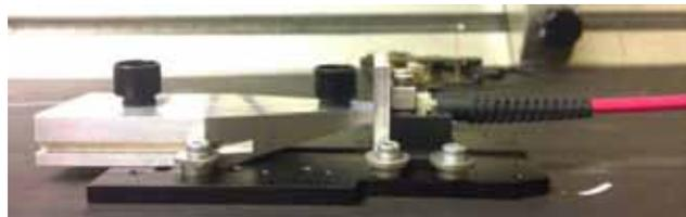
図 4: 実際の測定に用いた SciFi (左), レンズ (中央) および Clear Fibre (右)
