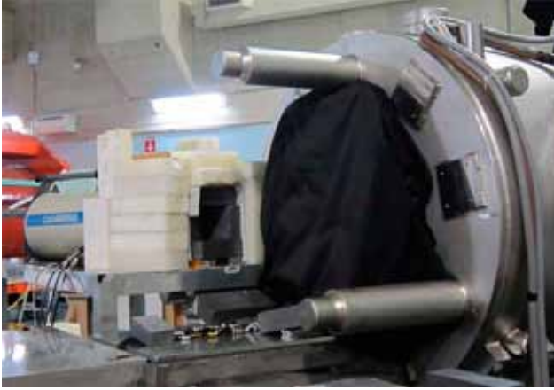
図 8: ミュオン X 線スペクトル測定時の実験セットアップ (2011 年 6 月測定時)。暗幕の中にトリガー用カウンターとマグネシウム板が設置されている。ゲルマニウム検出器の周辺にあるのはパラフィンなどの遮蔽体である。
