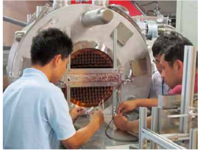
図 6: MuSIC 輸送ソレノイド出口に配置された寿命測定によるミュオン収量測定用の検出器。
