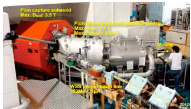
図 2: RCNP 西実験室に建設された大強度ミュオン源 MuSIC の写真。
