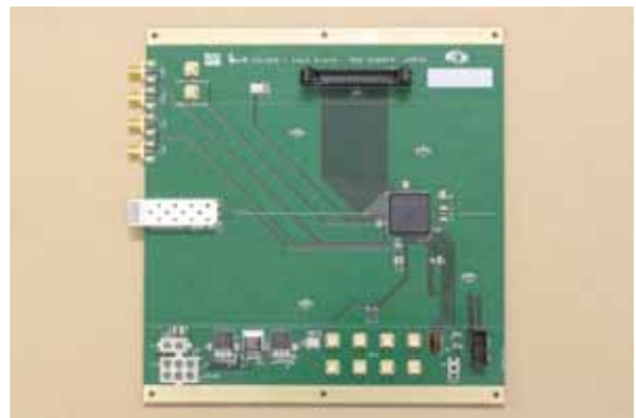
図 3-3 IGLOO2 FPGA 放射線耐性試験に向けたテストボード。
