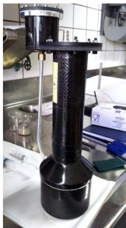
図 2 C_6D_6 を詰めた検出器 L_6D_6 。下方に C_6D_6 の容器が、上方に PMT が入っている。
