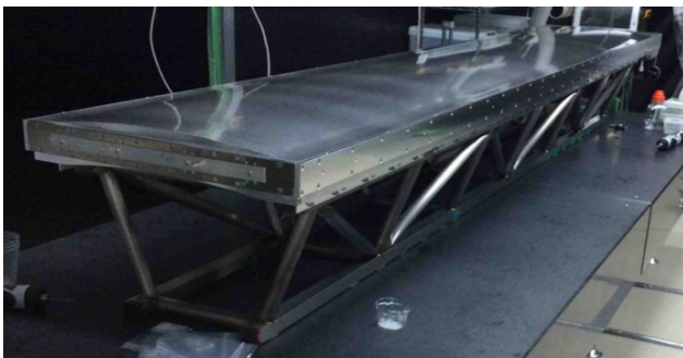
図 8: 構造体を組み付けた検出器モジュール。クリーンルーム (クラス 1000) 内の石定盤上で、トラス構造の支持構造体「ストロングバック」をインナーパネルに連結した状態で組み付ける。
