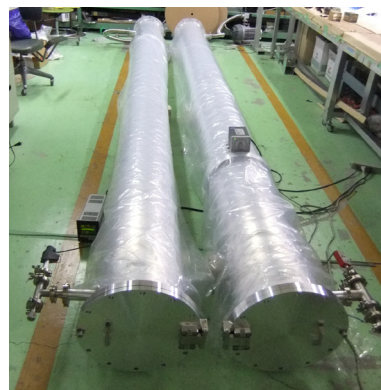
図 10: 真空引きのためのアルミ容器。内径30cm、長さ5m。それぞれに25枚のシンチレータが入る。
