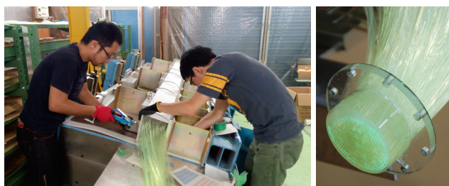
図11: 左) モジュール製作の様子。シンチレータ, 鉛板, サポート構造用のアルミ板を積層し, ステンレスバンドで9点縛る。右) ファイバーをまとめて樹脂で硬化後, 切り出して紙ヤスリにて磨いた状態。
