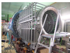
図15: メインバレルへの挿入直前の状態。
