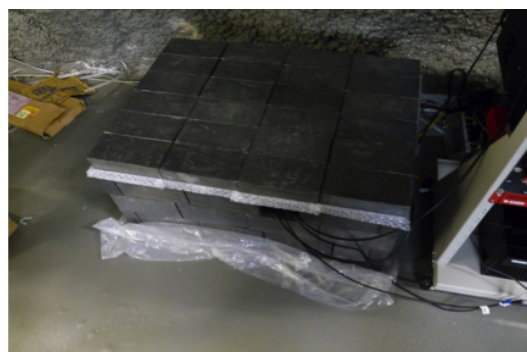
図 8: 神岡地下実験施設 Lab-B に設置された鉛シールド
