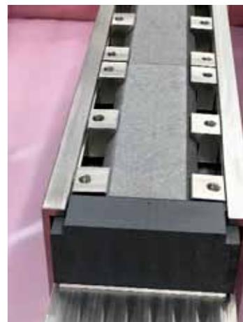
図11 CERN-HiRadMat での熱衝撃試験後の NITE-SiC (写真手前の黒い試料)。ビーム経路が観測される。
