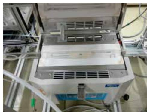
図 8 CROSS 東海の管状炉を用いた耐酸化試験の写真。
