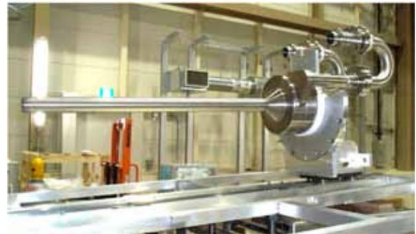
図 2 J-PARC ニュートリノ標的。チタン合金製の鞘の中に等方性黒鉛が格納される。
