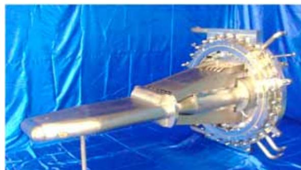
図1 J-PARC MLF 中性子水銀標的。ステンレス多重容器内を水銀、ヘリウム、冷却水が流れる。
