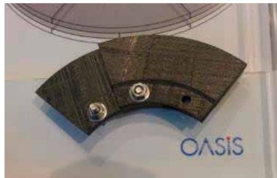
図10 OASIS グループで試作したミュオン標的模擬体。
