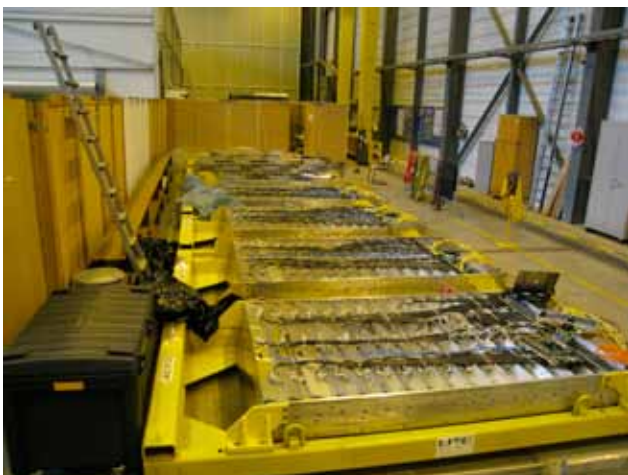
図 14: DCal スーパーモジュールのインストール前の写真 (ALICE point-2 にて)。2013 年 9 月撮影。
