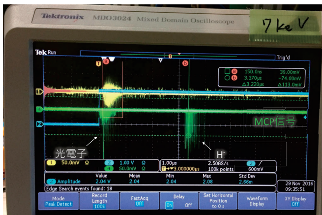
図 8: Soa レンズ内の標的部分で生成した光子と H^- を MCP で観測した際のオシロスコープ画像。緑が偏向電磁石の直進方向に設置したシングルアノード MCP による信号である。1 番目のピークが標的で生成した光子の信号であり、2 番目のピークが H^- 信号を示す。
