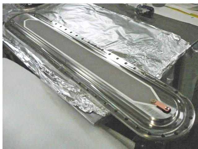
図 4 電子雲吸収用ストリップライン電極
