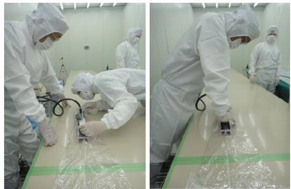
図 11 溶着作業。一人が溶着線を合わせて溶着バーをセットし(左)、もう一人の職人さんが溶着する(右)。
