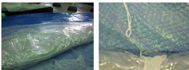
図7 折り畳まれ、フィルムカバーが巻きつけられているミニバルーン(左図)。フィルムカバーを押さえるメッシュシートと、メッシュシートを閉じているナイロンピン(右図)。
