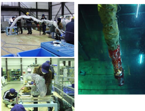
図8 インストールの様子(左上)と水中に投入後のミニバルーン(右)。およびフィルムカバーを上部から取り除いている様子(左下)。
