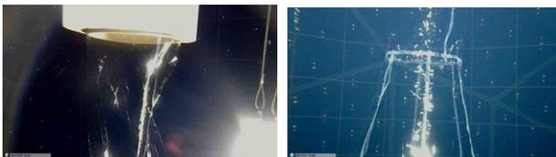
図 16 送液直後のミニバルーン直管部(左)と拡張後の直管部・コーン部の接続部(右)。
