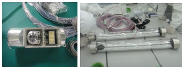
図13 Webカメラ2台を使用し、側面および底面を確認できる監視装置(左)とアクリルで封じられたLED照明(右)。
