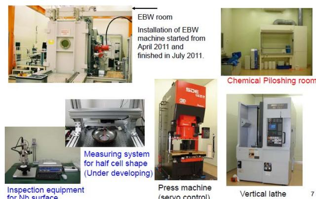
図3：空洞製造施設（CFF）に設置された主な製造装置。
