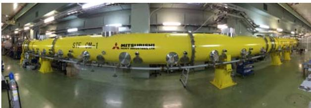
図9 完成検査間近のビームライン上に設置されたSTF-2クライオモジュール
