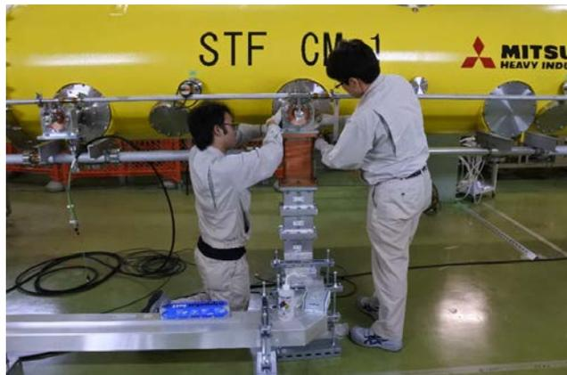
図 11 High power testの様子(上)と導波管切り替え作業の様子(下)。今回使用したクライストロンは量子ビーム計画で用いたもので、最大出力800kWの小型のタイプである。導波管系も入射部から30mほど下流側に延ばすことで対処した。
