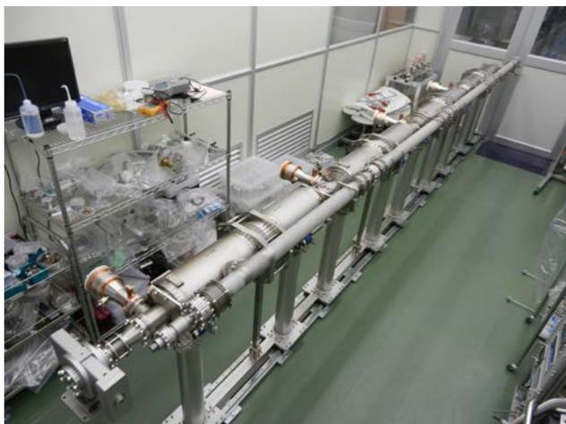
図6 Class10 クリーンルーム内でのカプラ取り付け(上), 空洞連結作業(中)および完成した4空洞の Cavity String の様子(下)。この段階で、空洞にはヘリウムジャケットとチューナー部品が溶接されており、空洞本体は見えなくなっている。
