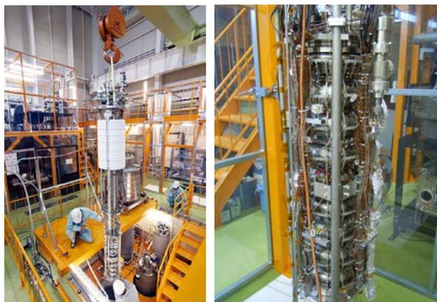
図3 空洞を縦型クライオスタットに入れているところ(左)と縦測定時の空洞に取り付けられたセンサー類(右)。センサーはカーボン抵抗による温度マッピングとPIN Photo DiodeによるX線マッピングがある。
