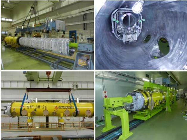
図8 クライオモジュールへの組み込み作業の様子(上左右)、トンネルへ下ろされるCM2a(下左)、トンネル内での作業エリア(下右)
