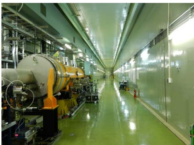
図2 2013年頃の STF トンネルの様子(手前に設置されているのが量子ビーム計画で用いられた Capture Cryomodule である)
