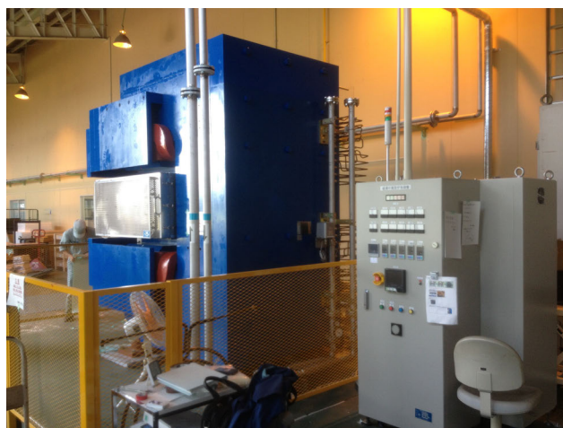
図 2: Kappa 電磁石を使った磁場中熱処理炉。Kappa 電磁石は改造により一回り大きくなっている。
