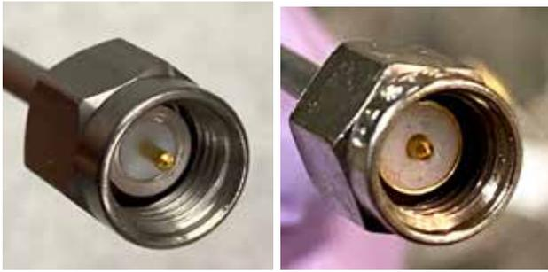
図 5: 健全な SMA コネクタ (左図) と、実際に埋没した SMA コネクタ (右図) の中心導体。
