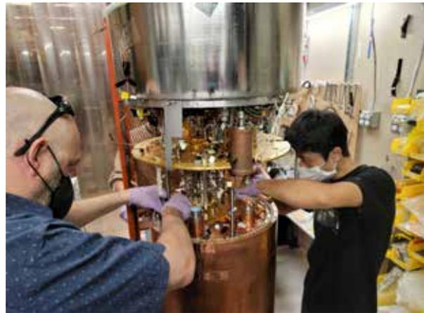
図 10: 2021 年夏から秋にかけておこなわれたメンテナンスの様子。銀色の円筒は液体ヘリウムのリザーバータンク (中に JPA などの量子アンプが収められている), 中間に RF システムや希釈冷凍機, 下部の銅色の円柱が共振空洞である。左が ADMX コラボレーション共同代表の Gianpaolo Carosi 氏, 右が筆者。
